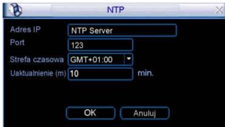
Rys. 5-10. Ustawianie parametrów NTP.
