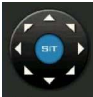
Rys. 4-32. Przycisk wielokierunkowy sterowania głowicą PTZ.
