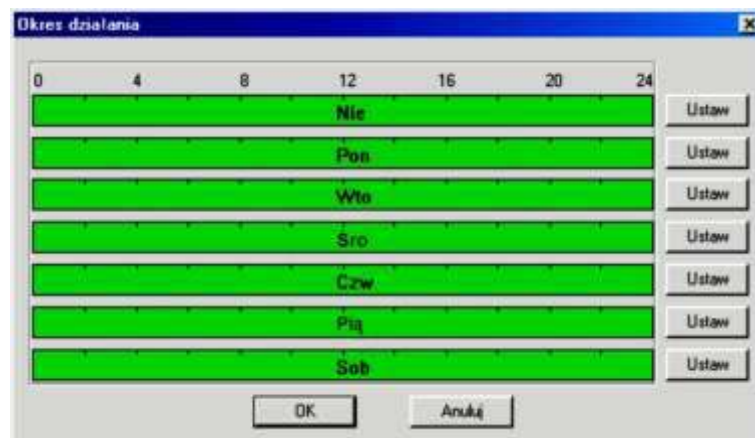
Rys. 7-38a. Ustawianie okresu aktywności wejścia alarmowego.
