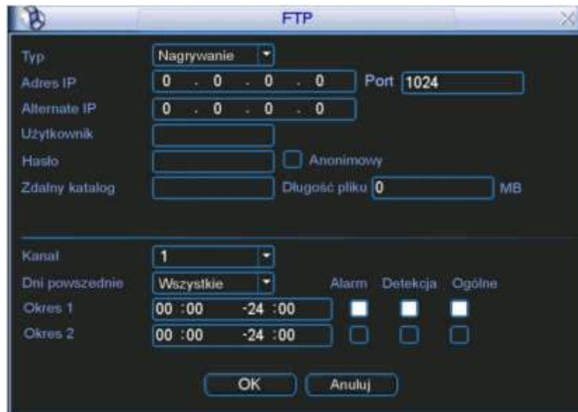
Rys. 4-16. Ustawianie parametrów serwera FTP.
